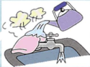
※熱湯を直接かけると水道管が破裂する恐れがあります
